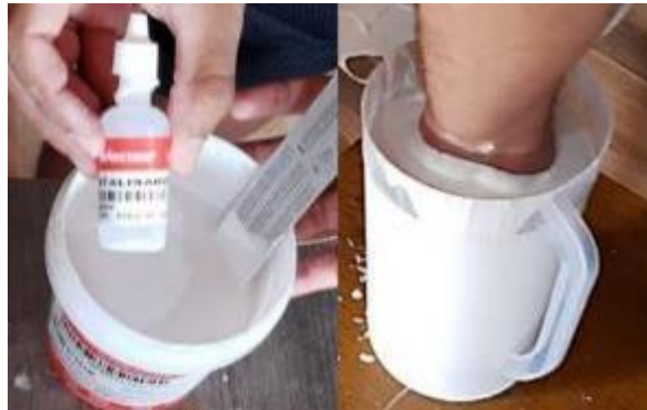
Figura 10: Mistura do silicone com o Catalisador, imersão da mão do usuário no molde de silicone.
