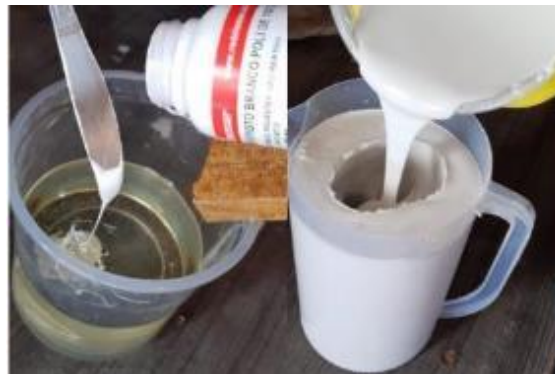
Figura 11: Mistura da resina com o pigmento, resina sendo adicionada no molde de silicone.
