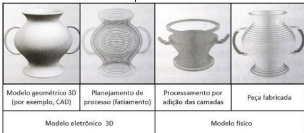
Figura 1: Representação gráfica das principais etapas do processo de MA ou impressão 3D.
