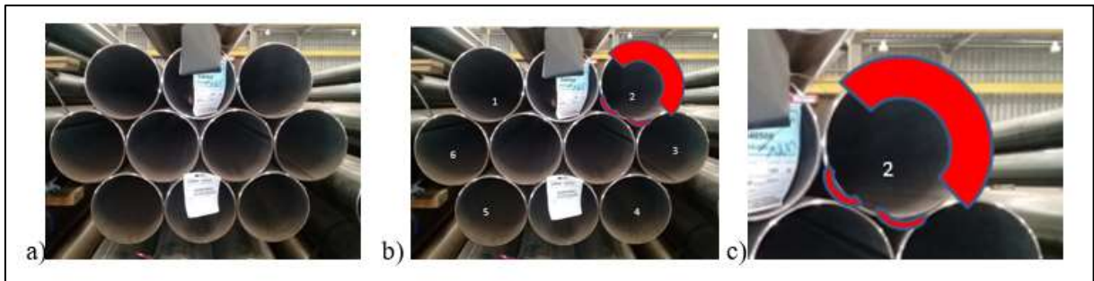
Figura 2 – a) Configuração da embalagem de tubos de aço. b) Na cor vermelha, uma representação gráfica da necessidade de forma do medidor e numeração de barras acessíveis a inspeção.
