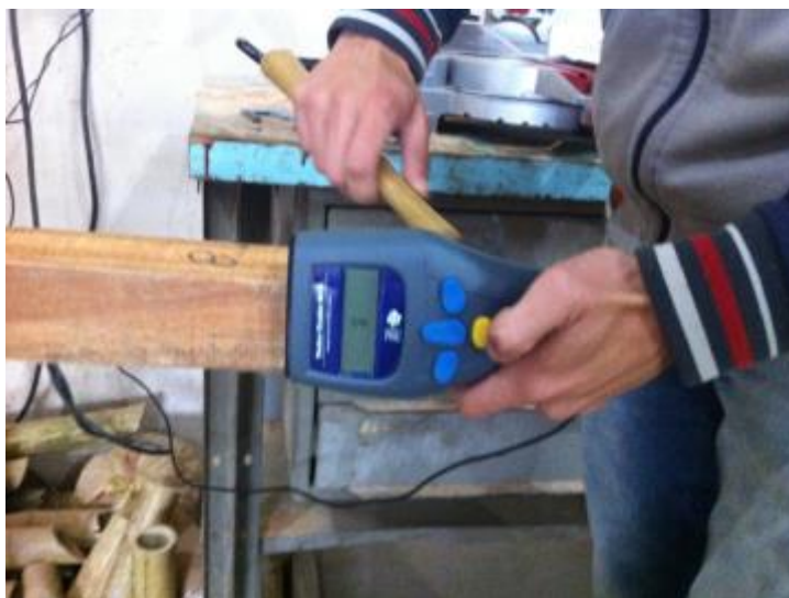
Figura 3- Medição do Módulo de elasticidade (MOE) através do MTG.
