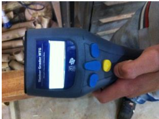
Figura 4- Aplicação do MTG para obtenção do MOE e resistência da madeira.
