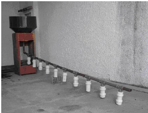
Figura 4 - Dispositivo para coletar separadamente os 10 primeiros milímetros da chuva
