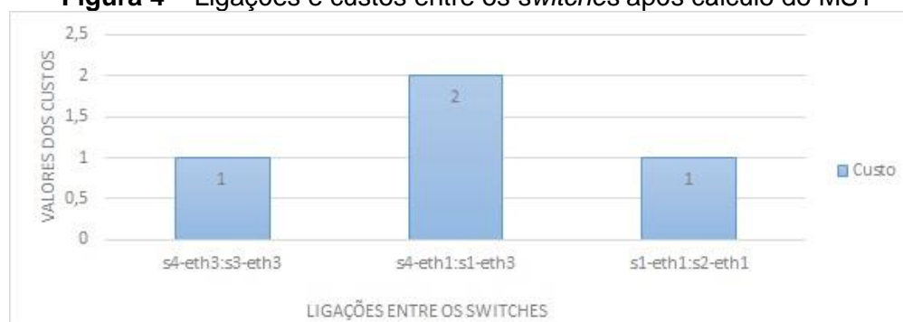
Figura 4 – Ligações e custos entre os switches após cálculo do MST
