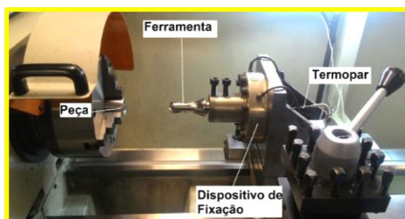
Figura 3 – Dispositivo utilizado para fixação da ferramenta no torno.
