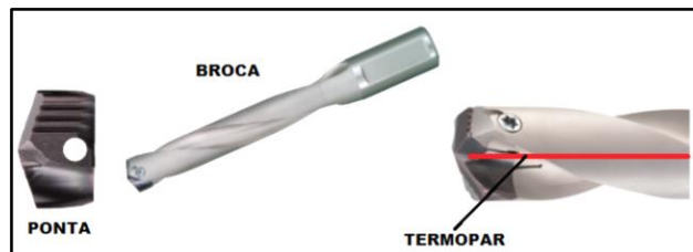
Figura 4 – Imagem representativa da ferramenta com adaptação do termopar
