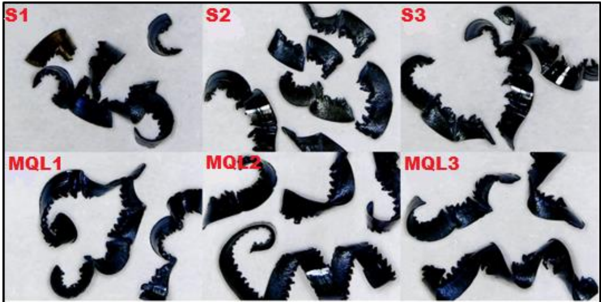
Figura 6. Cavacos coletados durante os ensaios a seco e com MQL.
