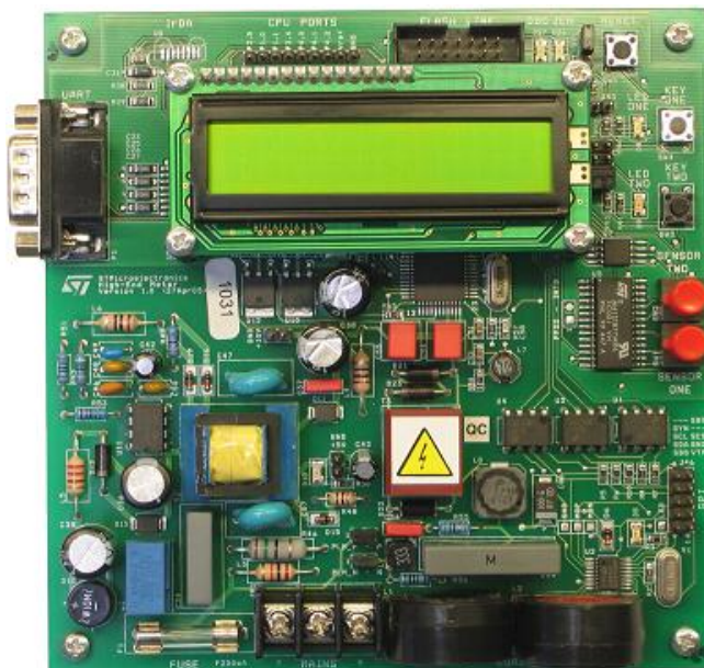
Figura 2 - Medidor de energia da STMicroelectronics
