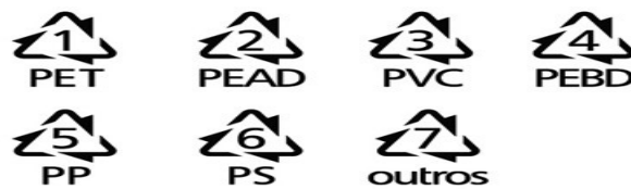
Figura 2 Principais símbolos utilizados para identificação de resinas termoplásticas para reciclagem
