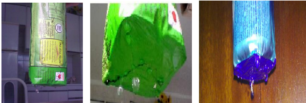
Figura 2 – Teste de vazamentos onde adicionamos água no interior da embalagem e determinamos o número de pontos com vazamentos no fundo das embalagens. Notar a ocorrência da formação de gotas no fundo das embalagens para biscoitos, 4 pontos de vazamentos para a embalagem azul, 7 pontos de vazamento para a embalagem verde a esquerda e 3 pontos de vazamentos na embalagem do meio.
