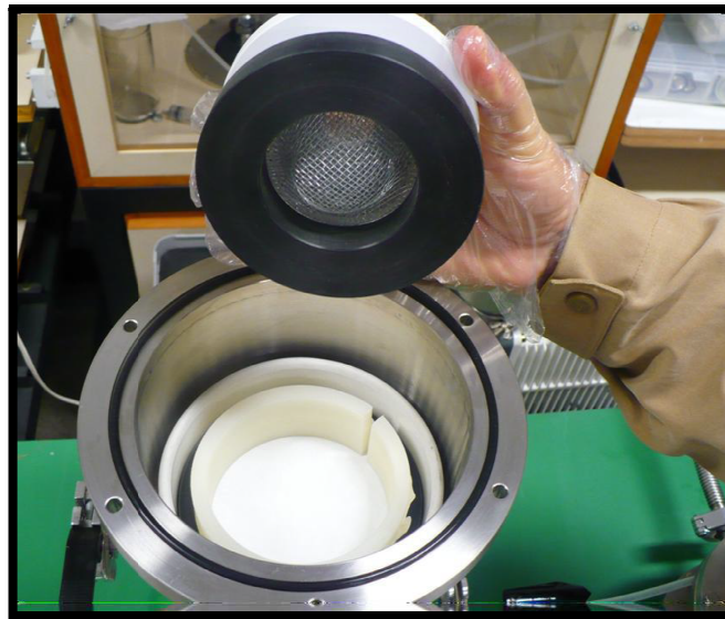
Figura 22. Vista sistema de chuveiramento e do funil de Buchner contendo papel filtro acomodado em suporte na câmara de vácuo superior.
