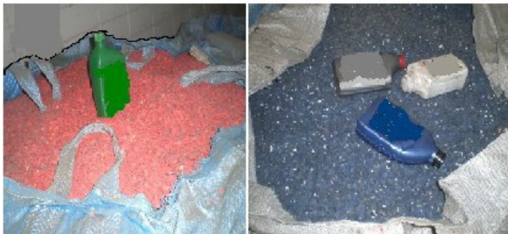
Figura 32 - Embalagens de lubrificante moídas para a produção de madeira plástica Fonte: Reciplast
