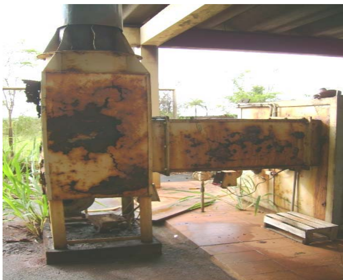
Figura 20 – Queimador desativado utilizado há décadas atrás para queima do resíduo hospitalar.
