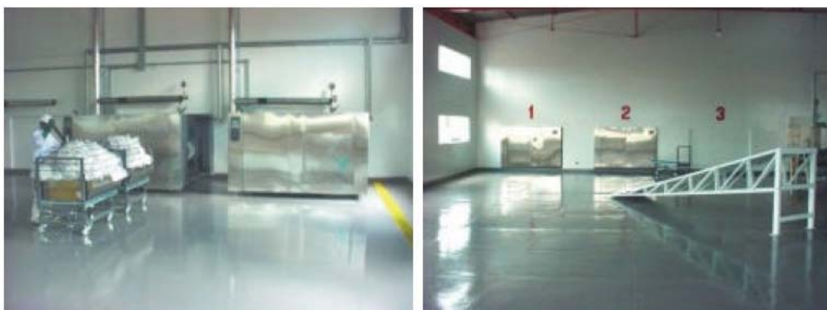
Figura 26 – Vista parcial da Unidade de Tratamento de Resíduos da empresa Constroeste Ambiental mostrando a autoclave e os carrinhos carregados de RSS prontos para o tratamento Fonte: CONTROESTE, 2010.
