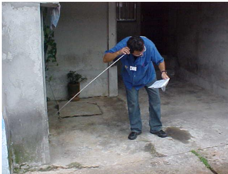
Figura 39 – Exemplo de utilização de haste de escuta
