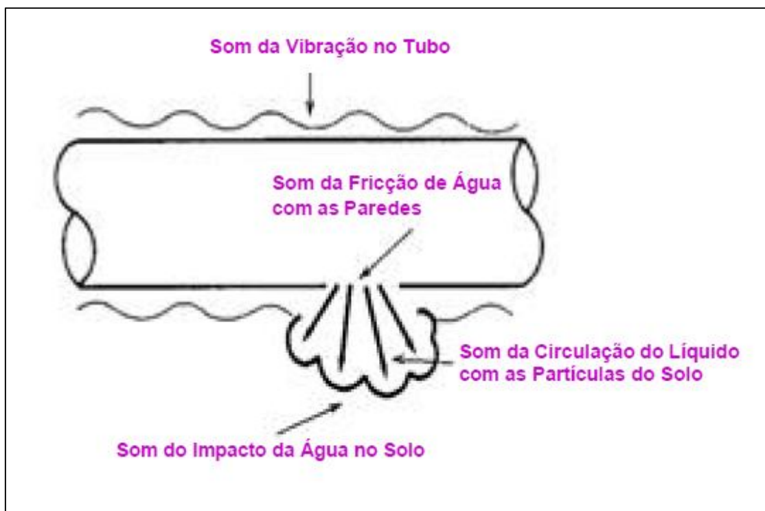
Figura 17- Propagação do ruído do vazamento não visível
