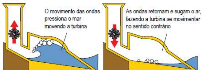
Figura 23 – Esquema da produção de energia elétrica a partir do movimento das marés
