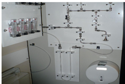
Figura 7. Padrão para vazamentos em que foram realizadas as medições para comprovar a sua eficiência.
