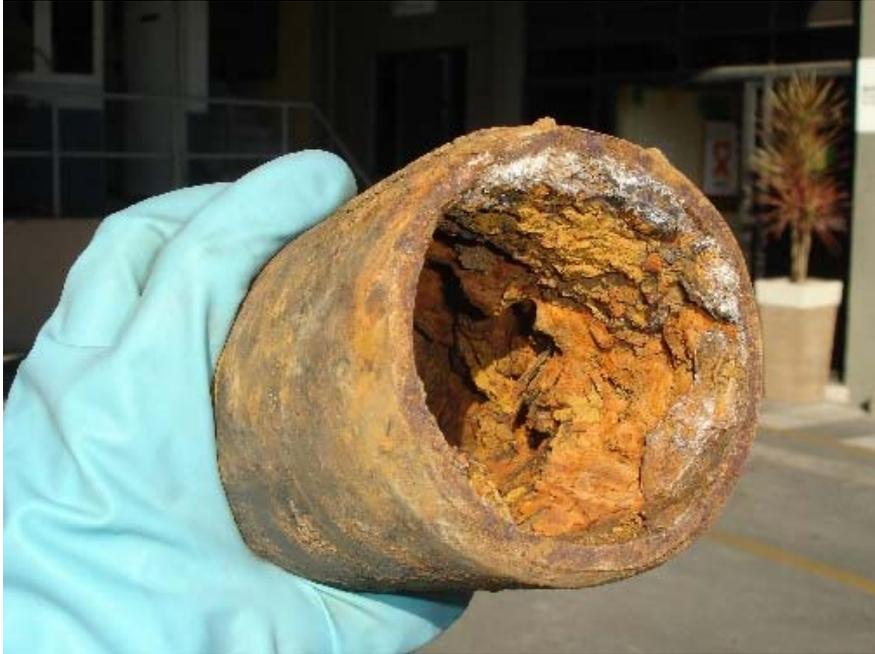
Figura 4. Tubulação de ferro fundido com tubérculos de cor castanho-alaranjada
