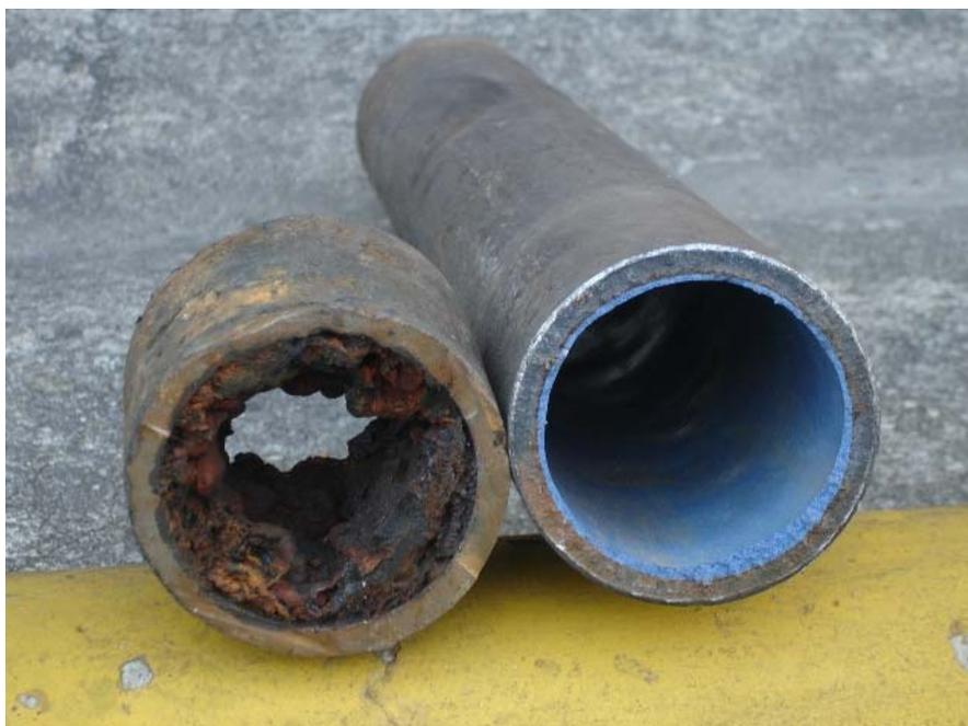
Figura 61. Amostras da tubulação de ferro fundido antes e depois dos serviços de limpeza e revestimento das redes – Setor de Abastecimento Jd. América
