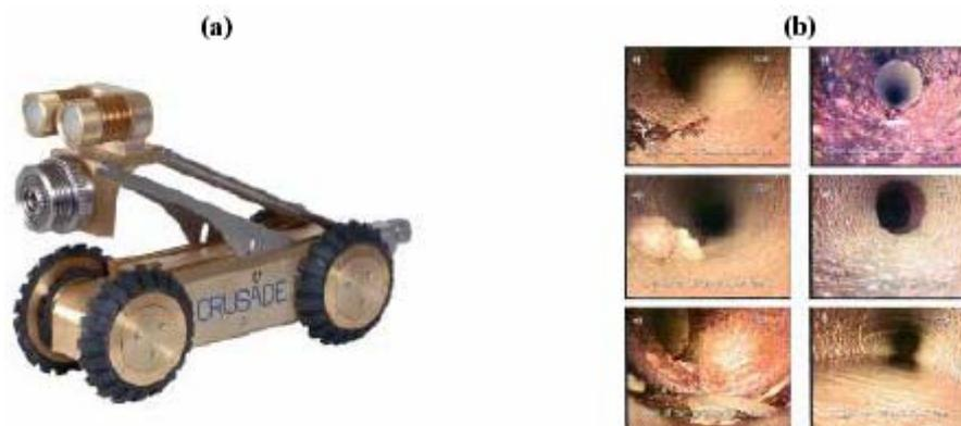
Figura 34. (a) Câmera CCTV utilizada na inspeção de redes; (b) Imagens de uma inspeção com câmera CCTV
