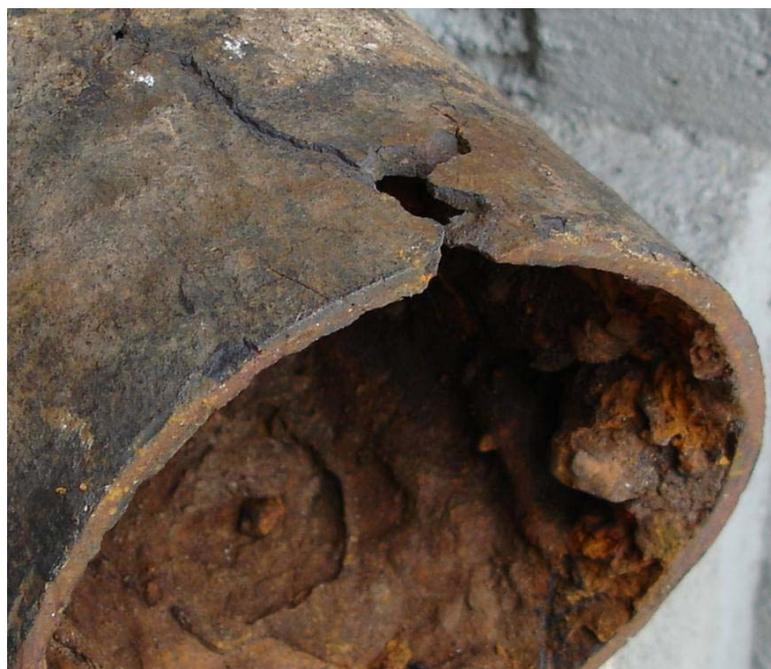
Figura 30. Amostra de tubulação de ferro fundido de 100 mm
