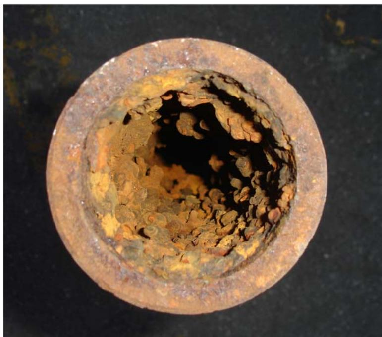
Figura 31. Amostra de tubulação de ferro fundido de 75mm
