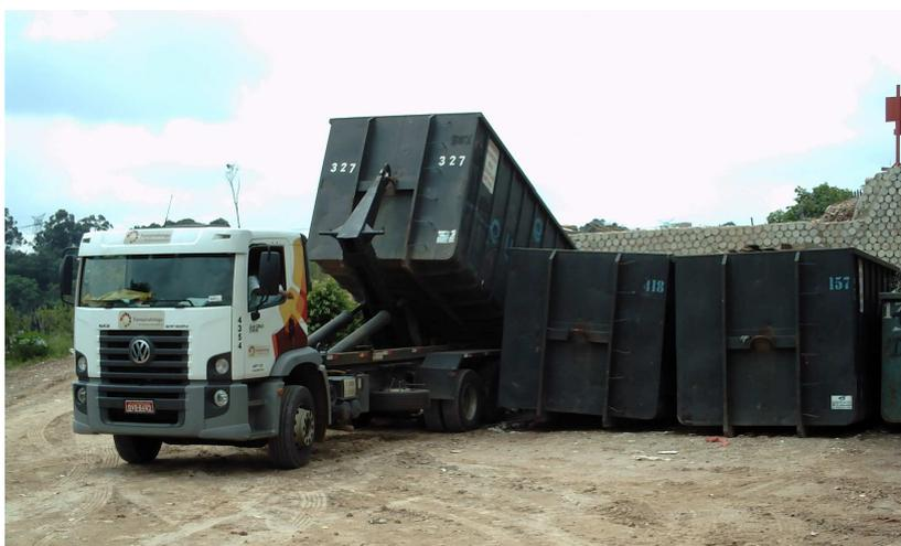
Figura 52 – Caixas estacionárias para coleta de resíduos de madeira em ATT
