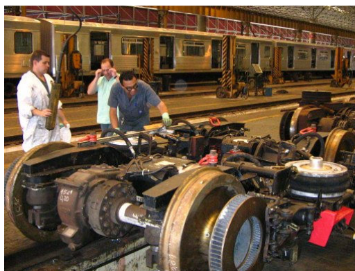
Figura 3 - Foto do truque durante processo de manutenção. Os motores de tração podem ser identificados com o auxílio da Figura 2.
