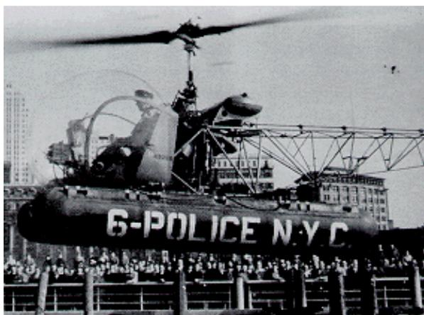
**Figura 16 - Bell Helicopter com flutuadores, usado pela NYPD**
