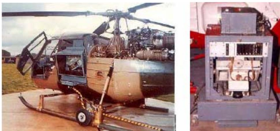
**Figura 36 - Equipamento de Downlink Marconi**
