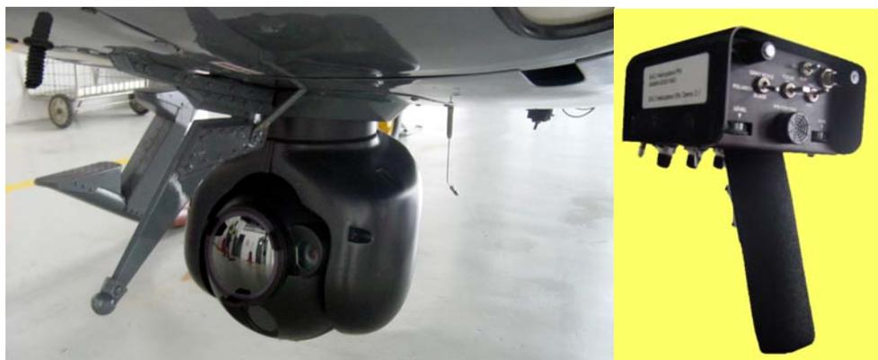
**Figura 33 - Torre Ventral e Unidade de Controle do FLIR 2000**
