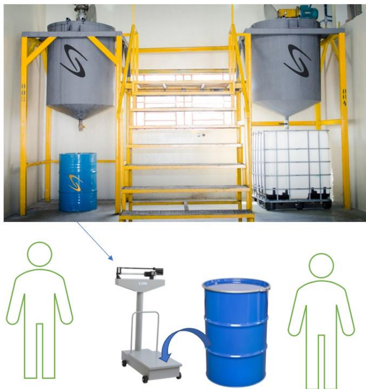
Figura 16: Ilustração na pesagem do produto final no tambor TR.
