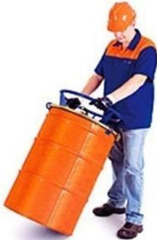
Figura 10: Exemplo de utilização do volante de movimentação de tambor.
