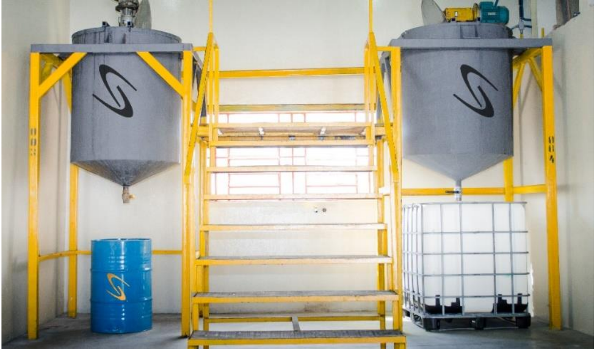
Figura 12a: Linha de Produção – Misturadores de 1000 Litros de Matéria Prima.
