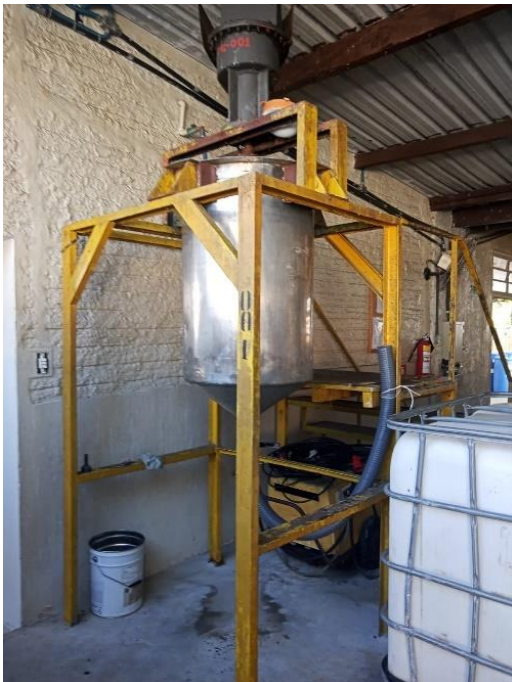
Figura 12b: Linha de Produção – Misturador de 250 kg de Matéria Prima.
