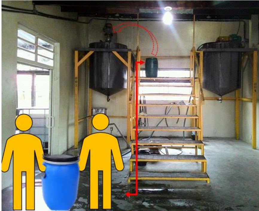
Figura 17: Ilustração da operação de Inserção de Matéria Prima no misturador.
