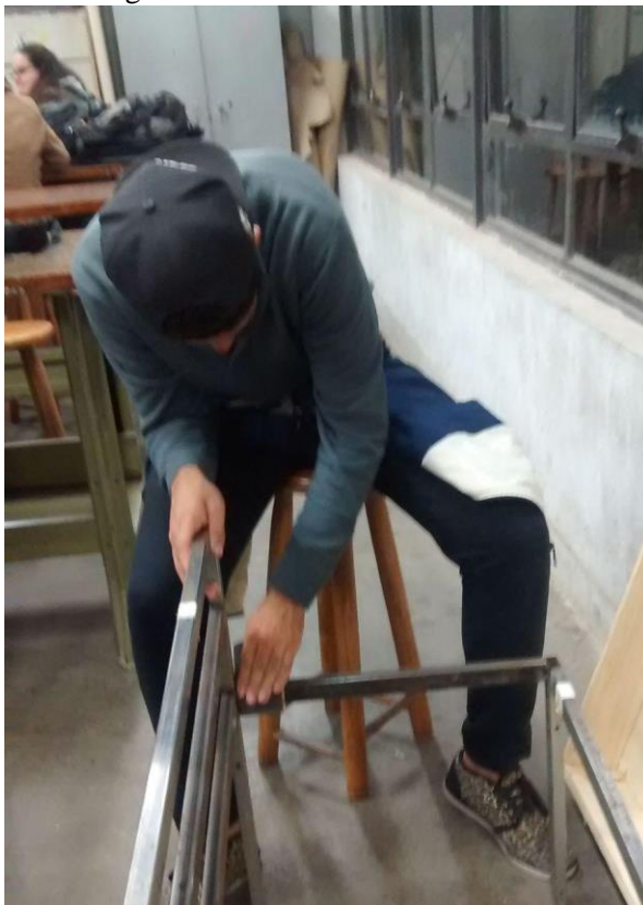
Figura 52 – Montagem do encosto do banco – estrutura metálica
