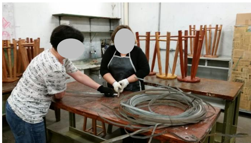
Figura 43 – Corte das fitas metálicas
