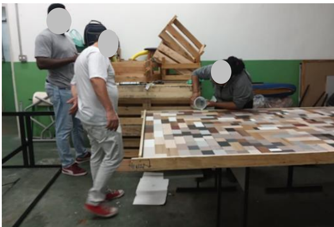
Figura 71: Aplicação da resina sobre a mesa
