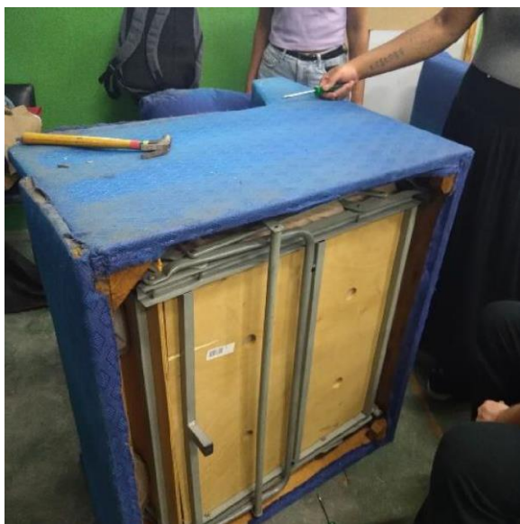
Figura 78: Processo de desmontagem da poltrona, utilizando ferramentas manuais, como chaves de fenda, alicates e martelos.
