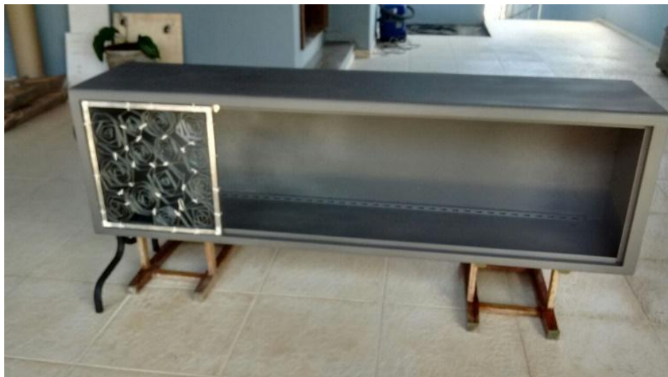
Figura 42 – Teste de fixação de rosáceas da porta (presas com barbante)
