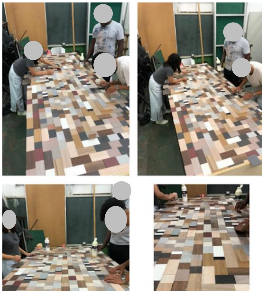
Figura 67: Montagem das plaquetas no estilo mosaico (marchetaria)
