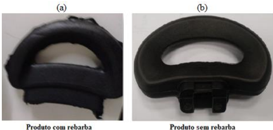
Figura 56- Comparação produtos injetados com e sem rebarba
