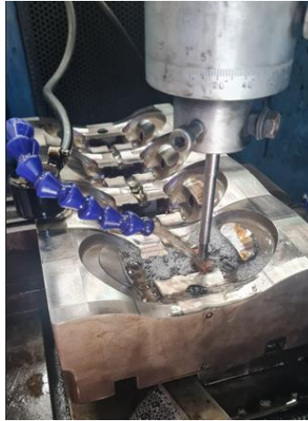
Figura 47- Operação de eletro erosão no retrabalho das cavidades
