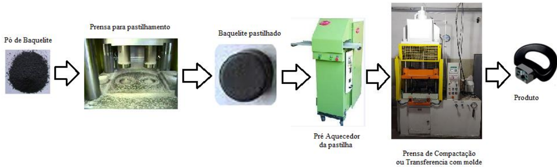
Figura 11- Representação esquemática do processo de moldagem por compactação e transferência
