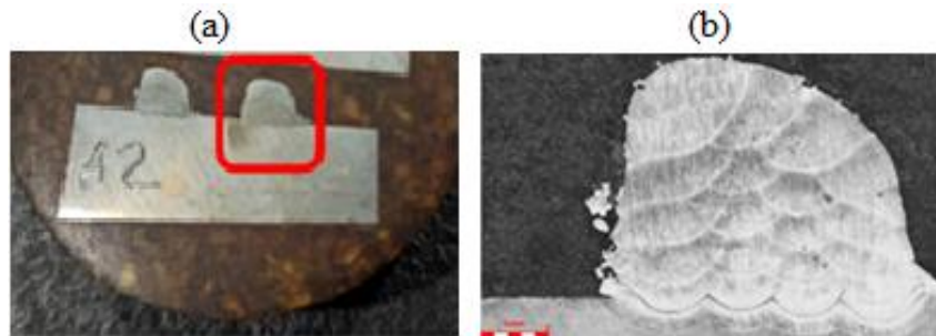
Figura 31- Ensaio de dureza e metalográfico
