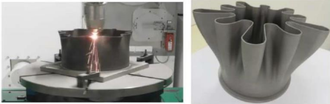
Figura 6- Representação da aplicação DED pelo processo da manufatura híbrida Fonte: https://blogs.autodesk.com/advanced-manufacturing/2018/11/29/greater-fuel-efficiency-in-aerospace/ . Acesso em: 2023
