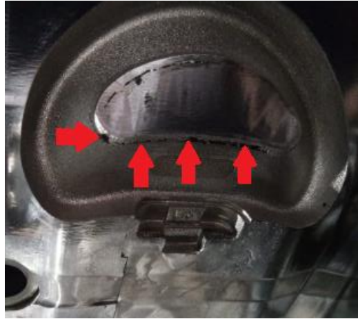
Figura 51- Trinca na cavidade
