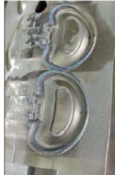
Figura 2 – Matríz com alojamento para Deposição
