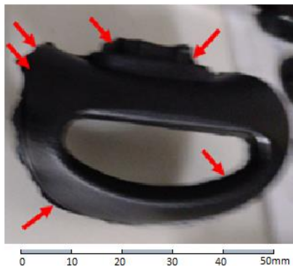
Figura 21- Peça injetada com excesso de rebarbas
