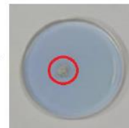
Figura 4 – Deposição com trinca
