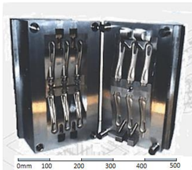
Figura 13- Representação da parte fixa e móvel do molde
