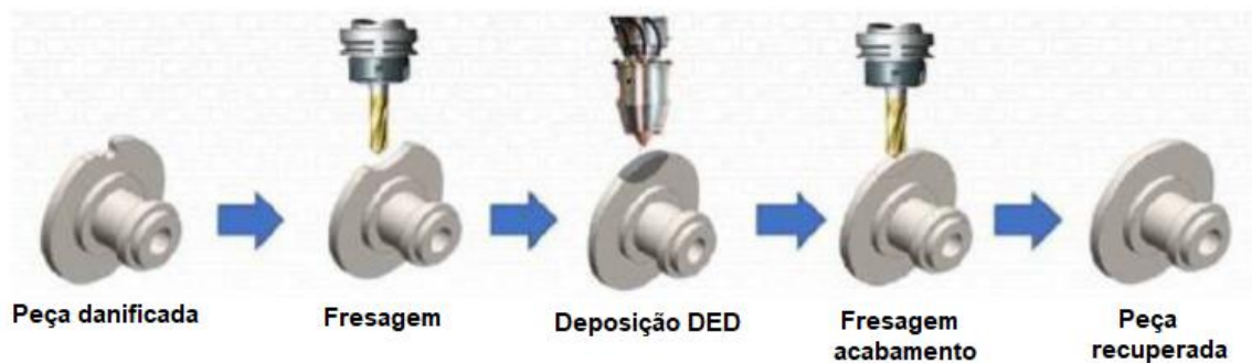
Figura 9- Representação da aplicação da manufatura híbrida no reparo de peças
