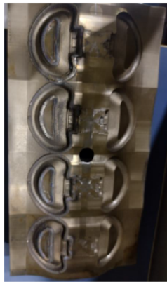
Figura 9 – Matriz concluída com deposição nas cavidades
