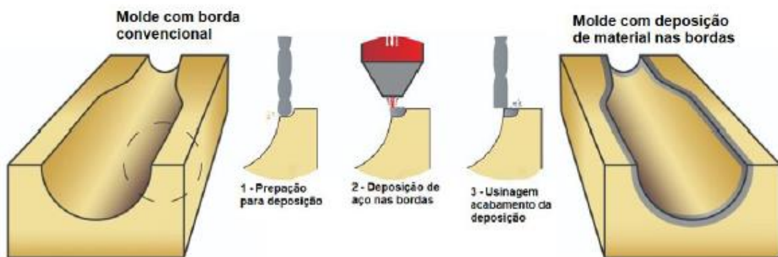
Figura 10- Representação de aplicação MHM em molde
