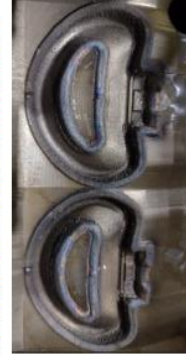
Figura 8 – Deposição na região interna da Matriz
