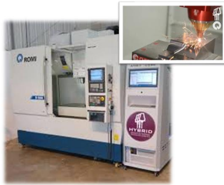
Figura 7- Máquina ferramenta CNC híbrida
