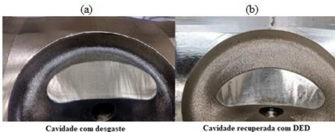
Figura 55- Comparação cavidades com desgaste x recuperadas com MHM
